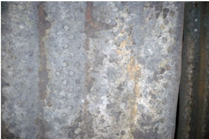
Defekte Stampfmasse vor dem Ausstrahlen.
