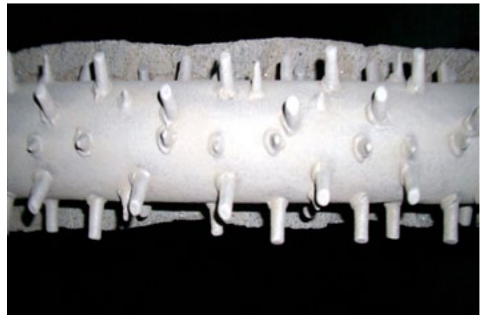
Defekte Stifte können entfernt und ausgetauscht werden.
